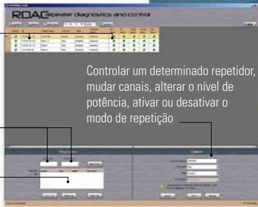
Controlar um determinado repetidor, mudar canais, alterar o nível de potência, ativar ou desativar o modo de repetição
